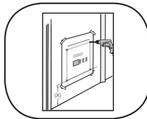
Coloque la base de la plantilla de corte a la altura de la panza marcada en la puerta (X). Taladre los orificios en las esquinas como se muestra.
