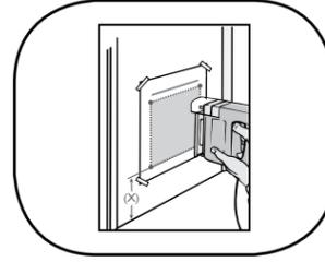
À l'aide d'une scie sauteuse ou d'une scie à guichet, découpez le long de la ligne de découpage tel qu'indiqué.
