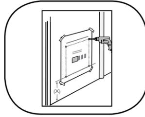
Plaats de onderzijde van het sjabloon voor uitsnijden op de buikhoogte die op de deur is aangegeven (X). Boor gaten op de hoeken zoals is aangegeven.
