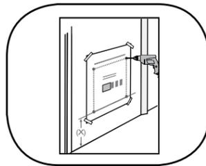
Positionieren Sie die Schneideschablone auf der an der Tür markierten Bauchhöhe (X). Bohren Sie die Löcher an den Ecken, wie in der Abbildung gezeigt.
