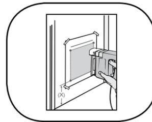
Mit einer Bogen- oder Stichsäge wie angezeigt entlang der Schnittlinie schneiden.
